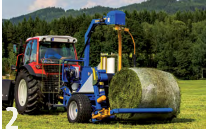
2. S nakládacím ramenem je balík zvednut na ovíjecí stůl &gt;&gt;
