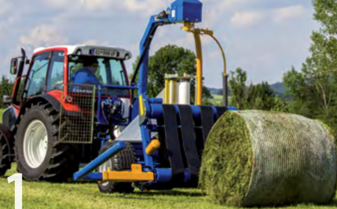
1. Ovíjecí stůl a nakládací rameno klesnou až k zemi &gt;&gt;
