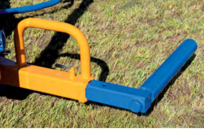
Otočné podávací rameno lze perfektně nastavit na průměr balíků.
