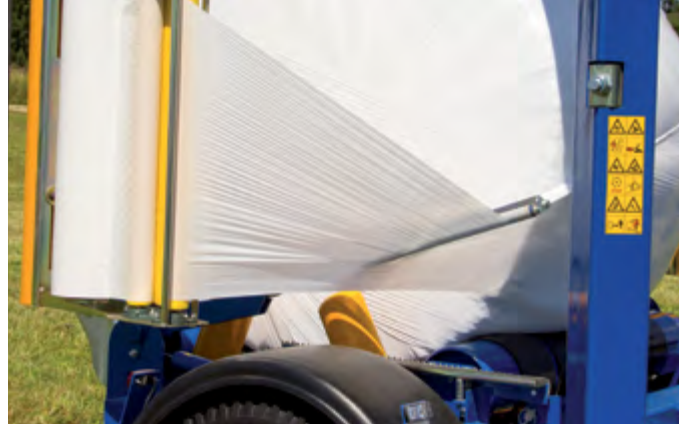
Fólie je pákou nůžek přitlačována proti ostrému kapovému noži.
