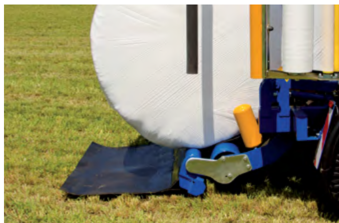
Odkládací rohož chrání balíky při odložení.
