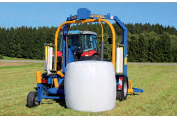
Se stavěčem balíků jsou balíky odkládány na čelní stranu.
