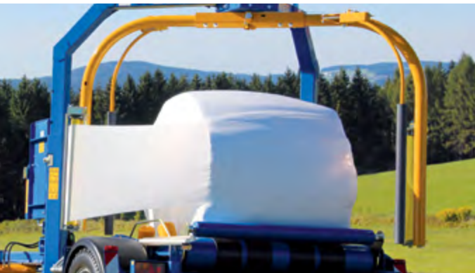
Při provozu s jednou fólií se snižuje rychlost posuvu.
