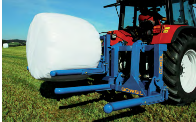
2. Hydraulický vozík zdvihá balík až do 380 mm >>
