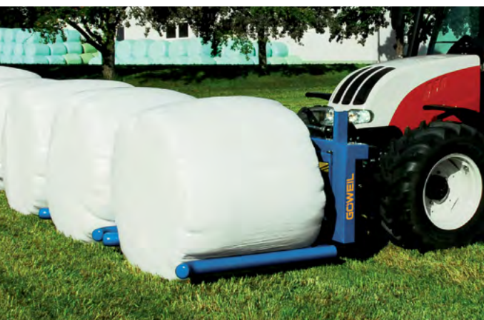
5. Současné odložení dvou balíků na skládku
